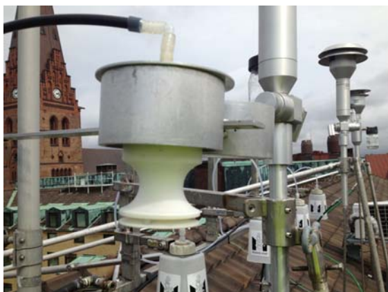
Figur 23. Filterprovtagare för mätning av tungmetaller och polycykliska aromatiska kolväten, monterad på Rådhusets tak
