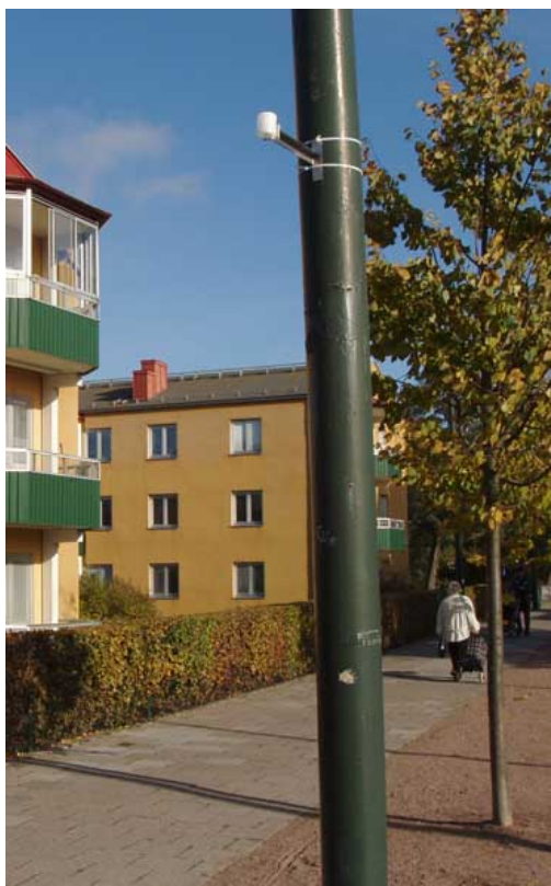
Figur 4. Provtagning av kväveoxider vid Vattenverksvägen med hållare och väderskydd (vänster bild) samt en principskiss över diffusionsprovtagarens delar (höger bild): (1) diffusor och förslutningsplugg; (2) rostfritt stål nät (diffusionsnät); (3) impregnerat NO 2 -provtagningsfilter (14,5 mm diameter); (4) Teflonring; (5) Teflonbricka; (6) hölje; (7) impregnerat NO x -provtagningsfilter (14,5 mm diameter).
